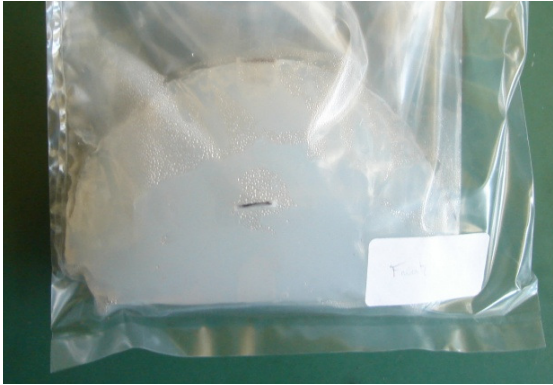
Figura 1: a. Fantoma de pulmón equivalente.
