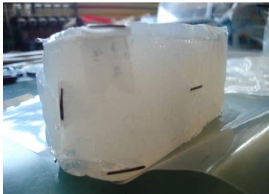
Figura 5: Fantoma con 14 alambres de activación de Cu-Au sobre su superficie y uno en su interior.
