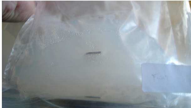
Figura 4: Fantoma con 7 alambres ( 2 en los laterales, 1 arriba, 1 abajo y 3 en el medio)
