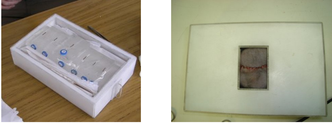
Figura 4. a) Fantoma de acrílico en el interior del contenedor blindado, sin la cubierta superior, en la posición de irradiación. b) Vista superior del arreglo experimental utilizado en la irradiación de ratas con un modelo de metástasis hepáticas.
