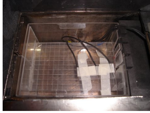
Figura 1. Disposición experimental de los detectores utilizados para realizar las mediciones en aire de flujo neutrónico a lo largo del eje central dentro de la facilidad de irradiación.
