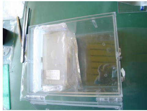
Figura 3. a) Vista superior del fantoma de pulmón con los alambres de activación dispuestos para la medición. b) Disposición de los bolus y el posicionamiento del arreglo experimental para la irradiación dentro del contenedor.
