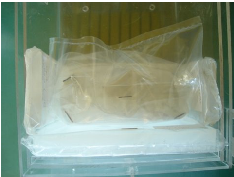
Figura 3. a) Vista superior del fantoma de pulmón con los alambres de activación dispuestos para la medición. b) Disposición de los bolus y el posicionamiento del arreglo experimental para la irradiación dentro del contenedor.
