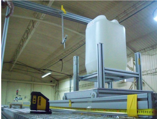
Figura 4: Fantoma colocado sobre la plataforma a 70 cm de la fuente.
