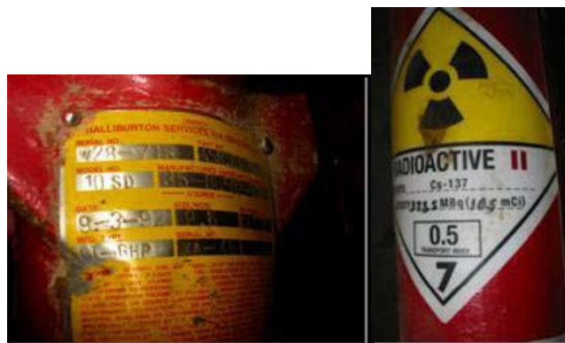
Plaqueta de identificación y etiquetado en buen estado (Cs-137)
