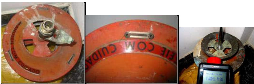
Pararrayos con radionúclido Am-241, identificado con el espectrómetro portátil
