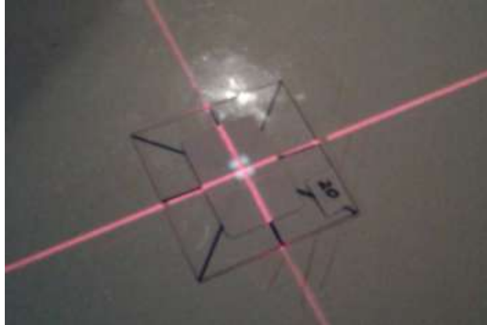
Figura 1.- Molde de PMMA con ranura de 1mm para alojar 20 TLD700.
