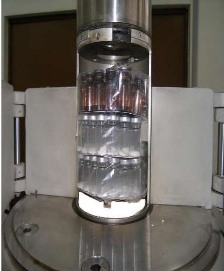
Figura 6.- Dosimetría en viales con hueso micro pulverizado en cilindro de irradiación
