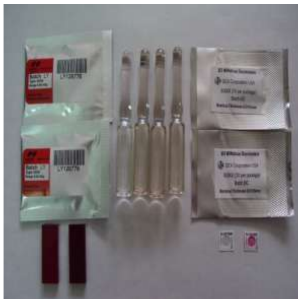
Fig.1 Sistemas dosimétricos Red Perspex, ECB y Film GEX B3000
