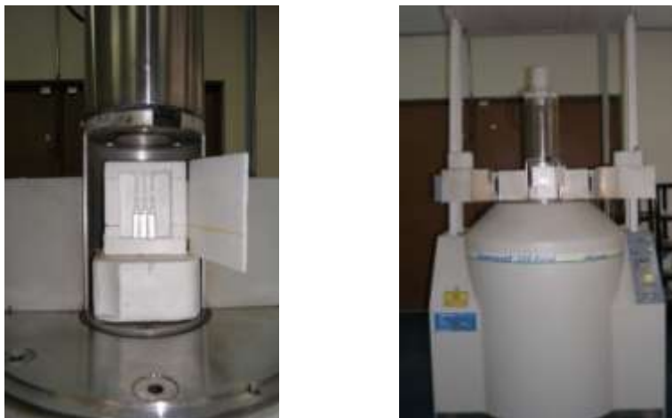
Fig. 2.- Dosimetría Fricke para determinación de la tasa de dosis en el punto central del cilindro de irradiación del Irradiador Tipo I Gammacell 220 Excel.
