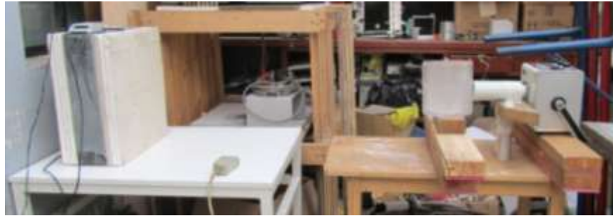
FIGURA N° 03 Sistema donde se muestra a la maqueta de drywall de 06 placas localizada al frente del equipo de rayos X.
