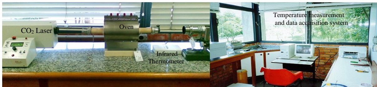
Figure 4: In house made bench for the thermophysical properties measurements. LMPT – Laboratório de Medição de Propriedades Termofísicas de Combustíveis Nucleares e Materiais.
