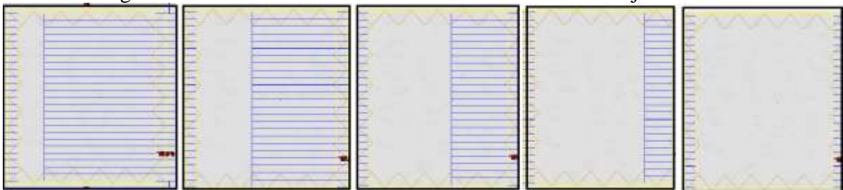
Figura 4.- Movimientos de DMLC para el test 4 simulando una cuña dinámica en dirección eje X.
