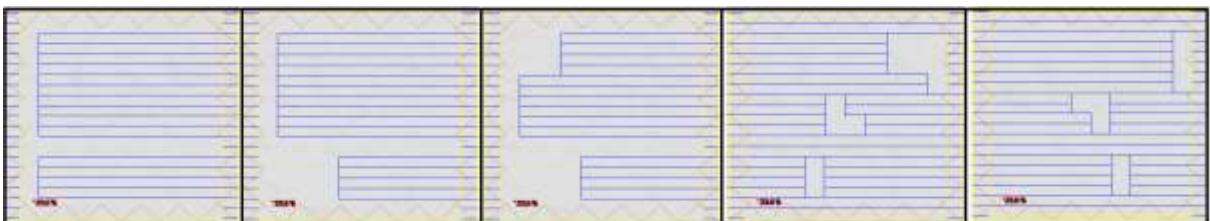
Figura 7.- Movimientos de las DMLC formando un campo complejo con diferentes intensidades.
