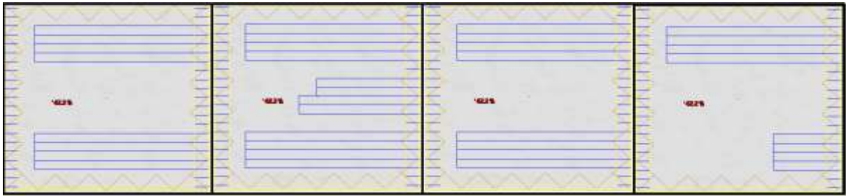
Figura 8.- Grafico indicando el movimiento de las DMLC formando un campo complejo con diferentes intensidades.
