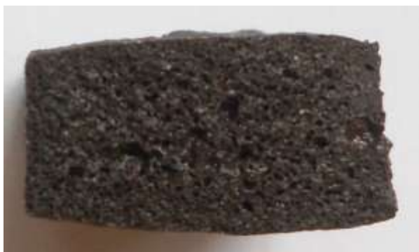
Figura 4 – Corpo-de-prova da Cerâmica 6 queimado à 1250°C.
