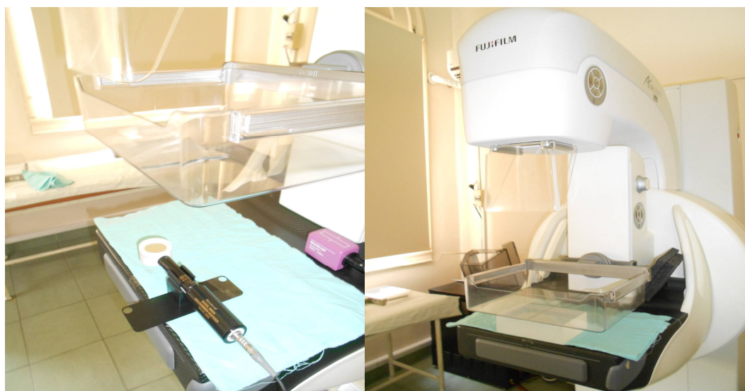
Figura 3. Medición de Kerma incidente en aire con la cámara de mamografía y obtención del mAs con fantoma de PMMA.
