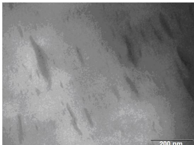
Figura 7. Micrografia de MET, para a amostra extrudada de PELMD/argila com aumento de 53000x.
