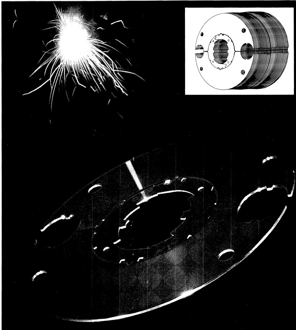
Die Spulen der ca. 6 m langen Magnete eines Speicherrings bestehen aus rund 3000 zusammengesetzten "Scheiben" zu je vier Feinschnittteilen. Geringste Mass- und Planheitsabweichungen würden sich addieren. Feintooling, die wirtschaftliche Kombination Feinschneiden/Umformen erfüllt diese höchsten Anforderungen.
