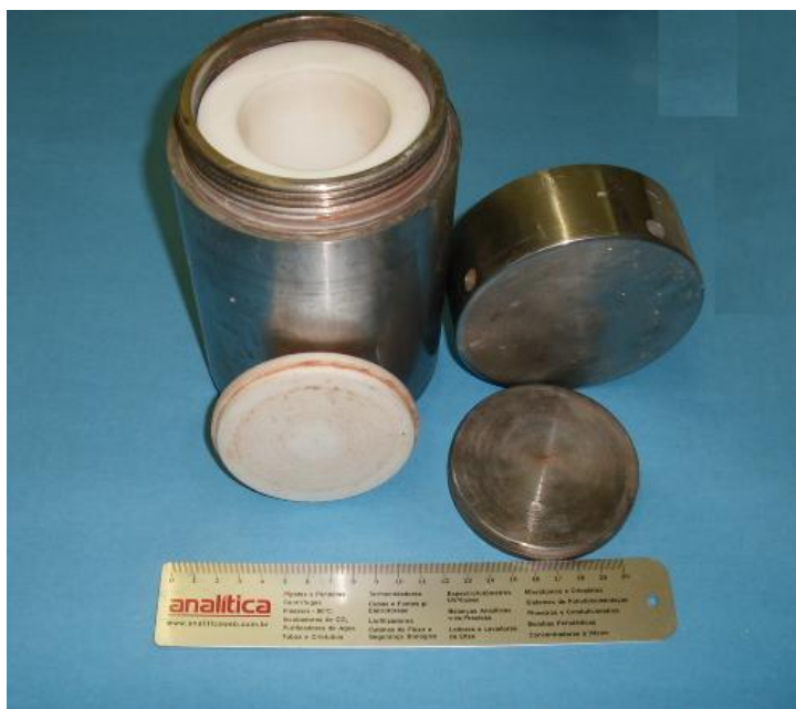
Fig. 02 - Mostra a autoclave usinada em aço inoxidável austenítico
