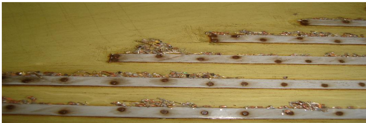
Figura 3 - Material em formato lamelar nos rifles da mesa vibratória.
