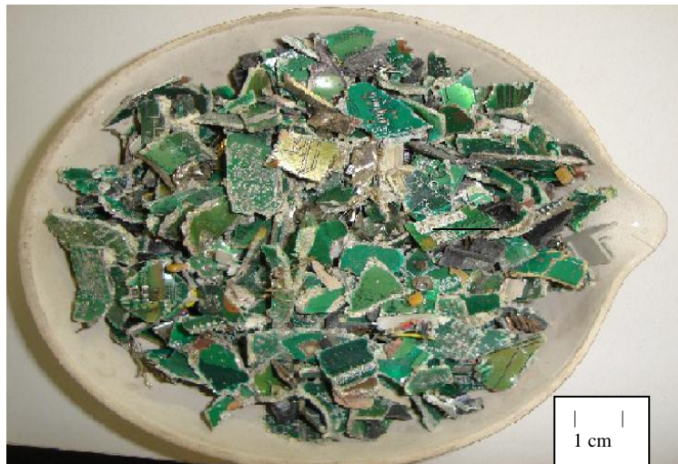
Figura 1 – Placas de circuito impresso descaracterizadas.
