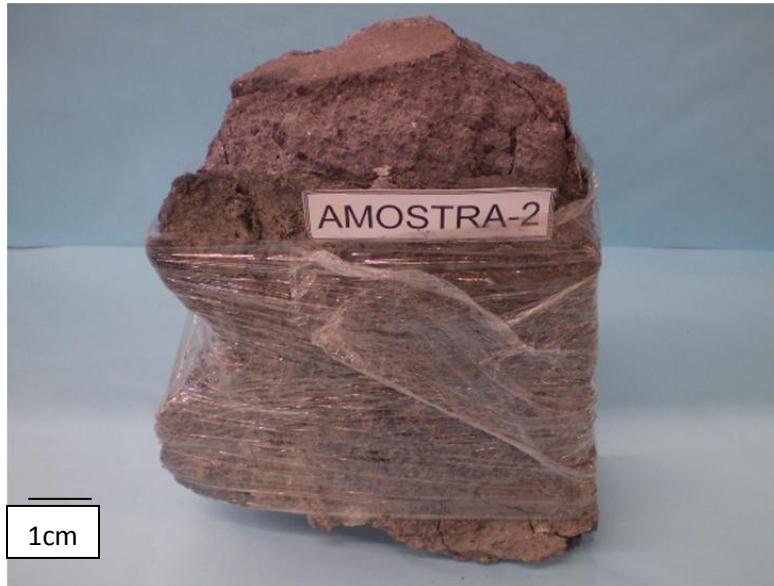
Figura A – Amostra que apresentou desgaste prematuro utilizada neste estudo.
