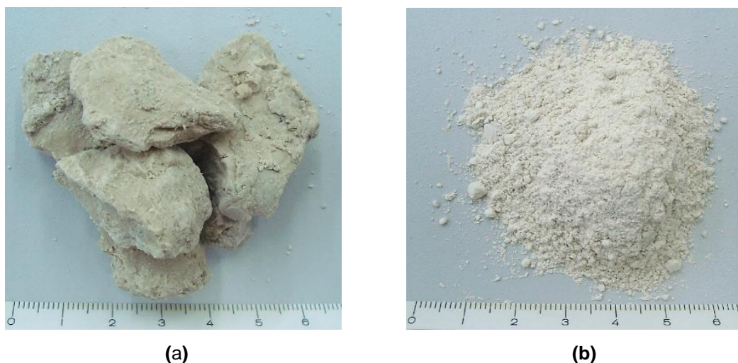
Figura 1 – Aspecto visual do resíduo de lapidação de vidros planos: (a) in natura e (b) seco.
