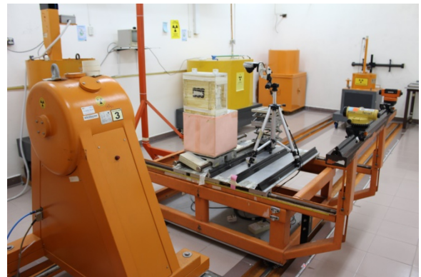
Rajah 4. Set-up penyinaran OSLD menggunakan punca gama Cs-137
