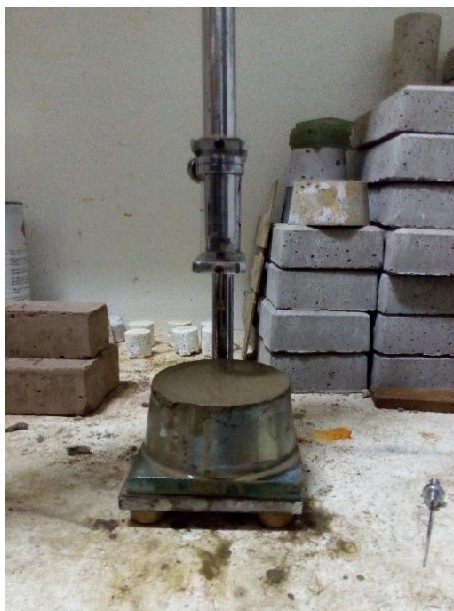
Figura 1 – Execução do ensaio para determinação dos tempos de pega
