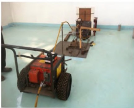
Gambar 4. Kamera isotop Co-60 dan Kolimator.
