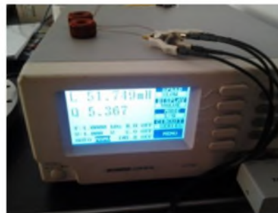
Gambar 4. Pengukuran koil Rogowski dengan LCRmeter
