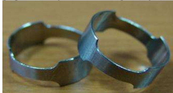
Fig.5. „Ring tensile test” samples
