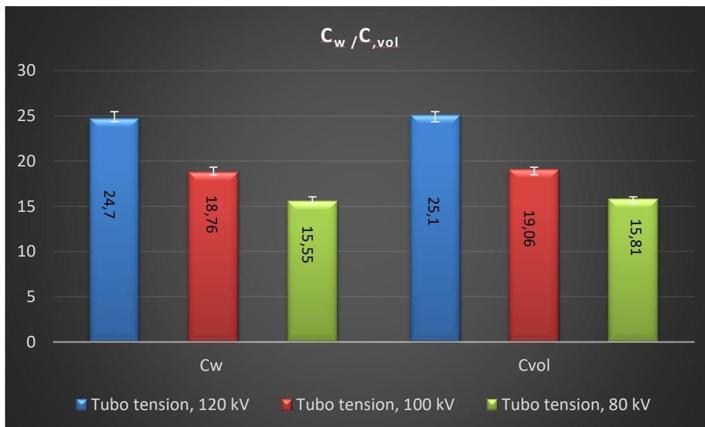
Fig. 4. Valores de índice de dose ponderado ( $C_w$ ) e índice de dose volumétrico ( $C_{vol}$ )
