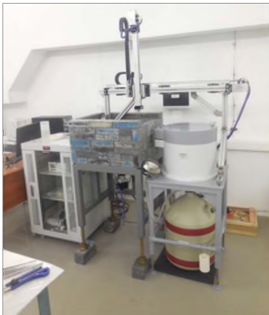
Рис. 6. Автоматическая система измерения спектров
