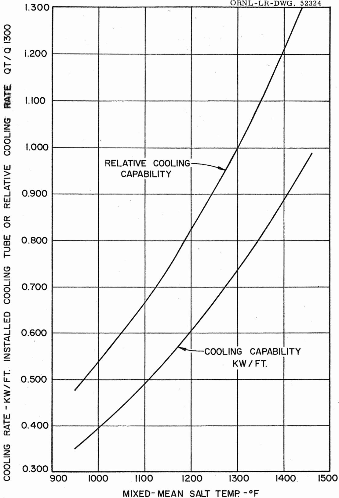
FIG. 3. COOLING CAPABILITY vs TEMPERATURE FOR CONCENTRIC TUBE DRAIN TANK COOLER USING 1.5" O.D. x 0.049" WALL STAINLESS TUBE INSIDE 2.0" O.D. x 0.072" WALL INOR-8 TUBE.
