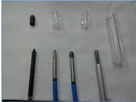
Gambar 2. Dari kiri, detektor volume 0,007cc, volume 0,016 cc, volume 0,125 cc, dan volume 0,6 cc tipe PTW TW 30013 no. seri 6367
