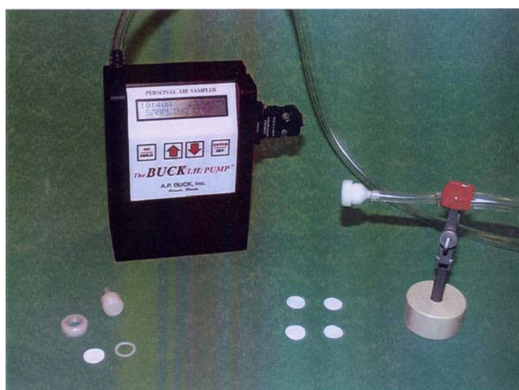
Fig.12 Prélèvement du mercure particulaire de l'air ambiant. Photo tirée de l'étude INERIS 1998
